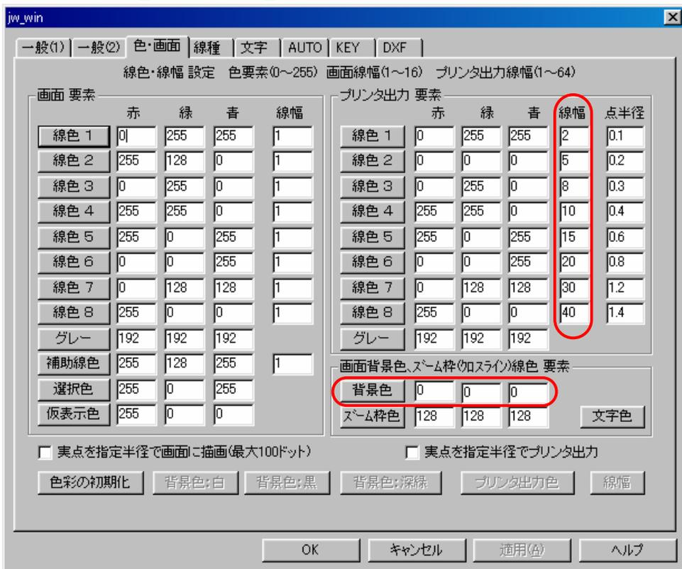
線色・線幅設定 色要素(0~255) 画面線幅(1~16) プリント出力線幅(1~64)
